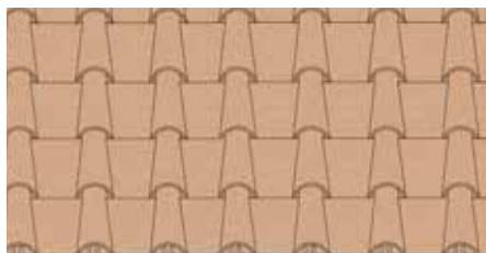
Opečna kritina ni primerna zaradi prevelike obtežbe na obstoječo leseno konstrukcijo.
