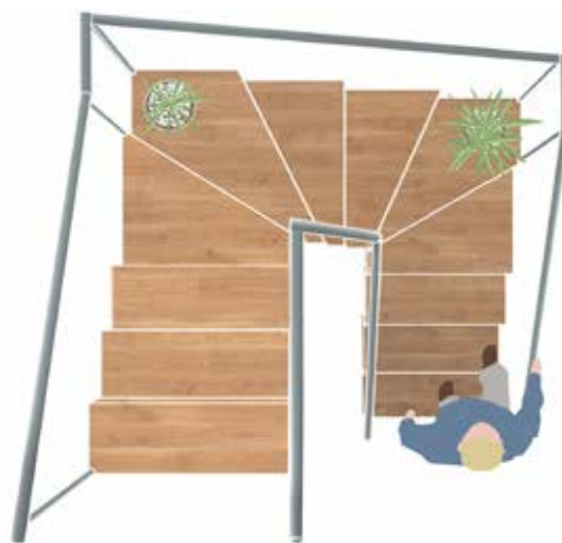
Novo stopnišče v obstoječi odprtini.
