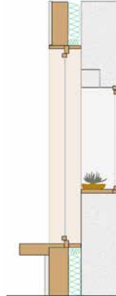
Slika 5: Primer vgradnje okna pri hiši Trnovec z dodatno notranjo leseno konstrukcijo.
